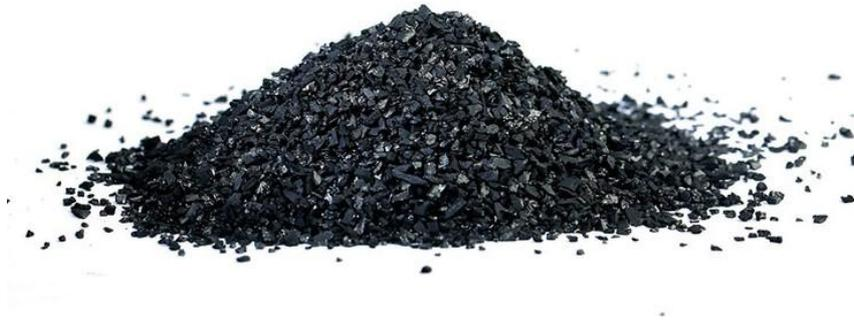
Le charbon actif en grains a un niveau d'activité élevé et est issu d'une matière première de très haute qualité. Sa microporosité développée le rend particulièrement adapté à l'élimination de composés organiques à faible poids moléculaire ainsi que de leurs sous produits de chloration comme le chloroforme, autres trihalométhanés et aussi à l'élimination des oxydants tel que le chlore et l'ozone.
