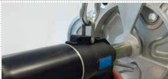
Accessoire spécial : **adaptateur angulaire** pour le respect de la perpendicularité nécessaire par rapport au composant.
