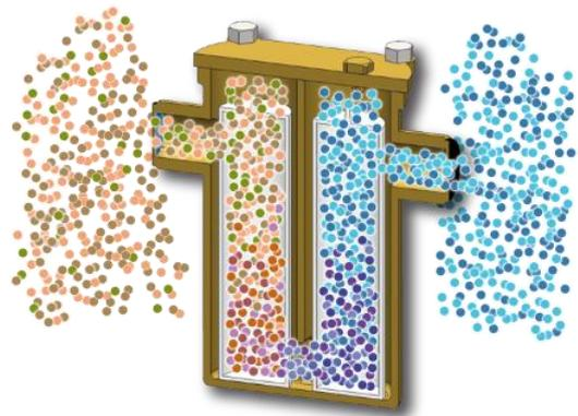
Notre principe actif agit comme inhibiteur de cristallisation ou de corrosion et consiste à ajouter d'infimes parts de phosphate complexe.
