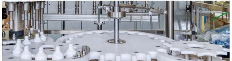
Équipement de capacité de production moyenne, avec connexion à distance, solution complète de remplissage, bouchonnage et étiquetage dans un petit espace.
