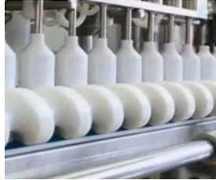
Machine adaptable en hauteur entre 110 et 320 mm et de 45 à 160 mm de large.
