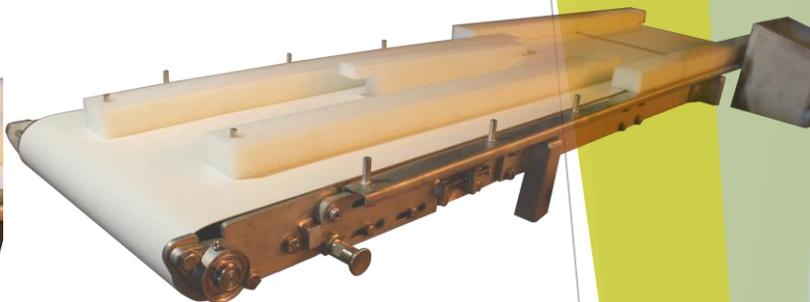
Des systèmes rapides et sans outil de montage, de démontage et de mise en tension des bandes facilitent les interventions de maintenance.
