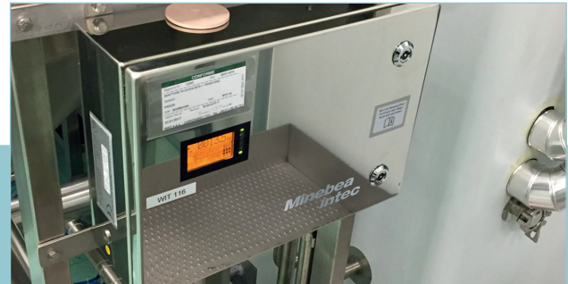
Les capteurs de pesage et les électroniques de pesage Minebea Intec permettent un pesage fiable des cuves de processus
