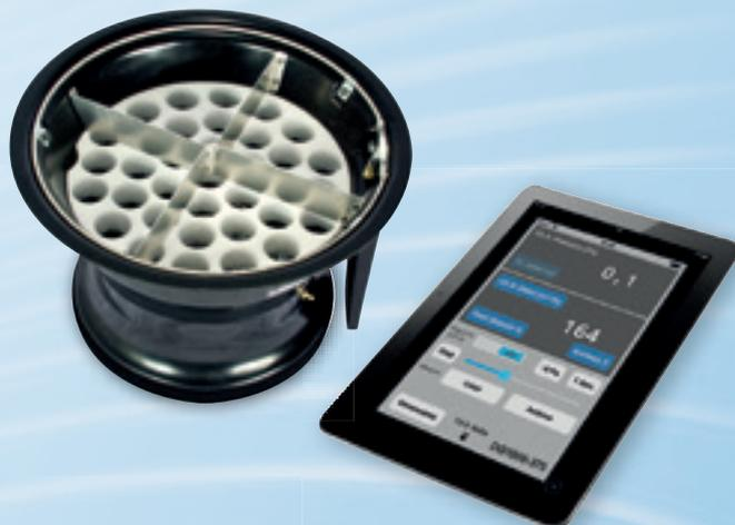
Les valeurs mesurées aux bouches d'insufflation ou d'extraction d'air, peuvent être enregistrées – soit manuellement, soit en connexion WiFi – avec le logiciel TECLOG (optionnel) ou avec l'App TEC Gauge.
