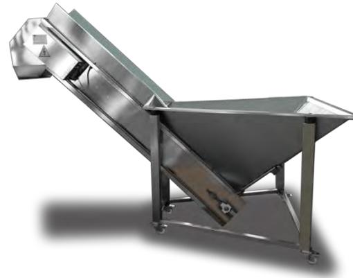
En début de ligne pour alimentation de la chaîne pommes de terre /oignons ... Avec un vibreur en bas pour éviter bouchon et blocage d'étranglement. Nous fabriquons également des trémies de plus grande capacité pouvant stocker jusqu'à 3 mètres cubes. Le trémie peut alimenter un épierreur pour le nettoyage de lots de pommes de terres avec déchets. Et terre ou une laveuse à eau et une calibreuse.
