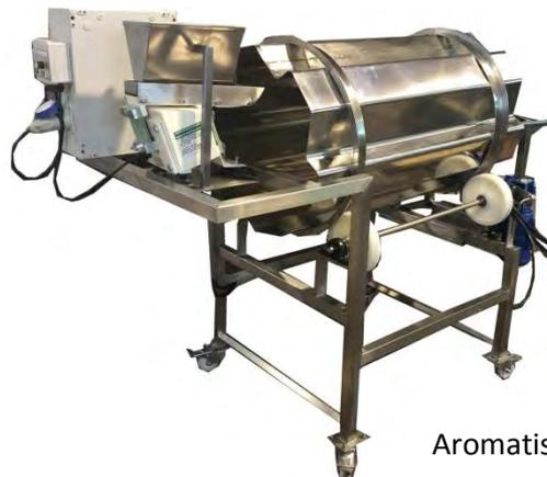
Aromatiseur Chips existe aussi modèle électrostatique
