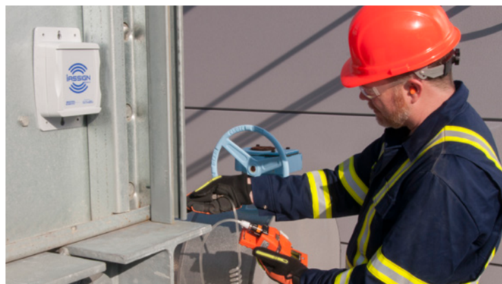
Balises iAssign – Affectent automatiquement les noms des sites aux détecteurs multi-gaz de la série Ventis™ selon la proximité, permettant ainsi aux responsables de la sécurité de situer la survenue des dangers et d'identifier les personnes impliquées.
