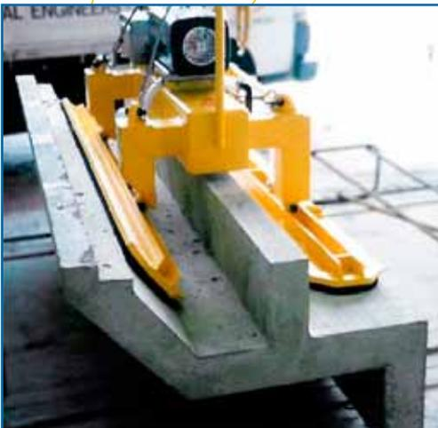
• Démoulage et manutention des trottoirs du tunnel sous la Manche. 100 000 pièces réalisées.
