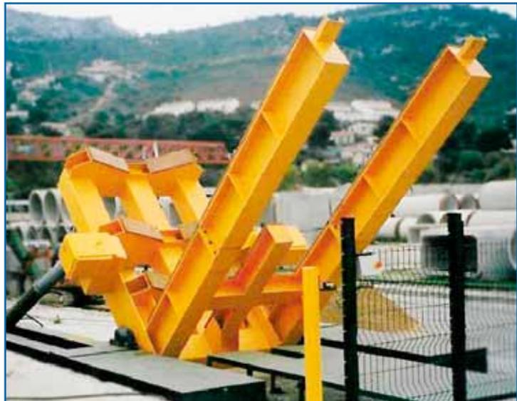
• Basculeur mécanique pour tuyaux béton. CU 25 000 kg.
