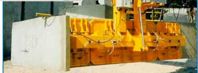
• Démoulage, basculement pour le séchage sur parc de murs en L. CU 16 000 kg et 8 000 kg.
