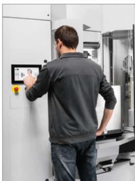
HS flex avec deux modules de magasin de palettes et poste d'équipement, adapté pour un centre d'usinage C 42 U.
