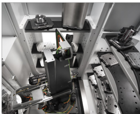
HS flex avec deux modules de magasin de palettes et poste d'équipement, adapté pour un centre d'usinage C 42 U.
