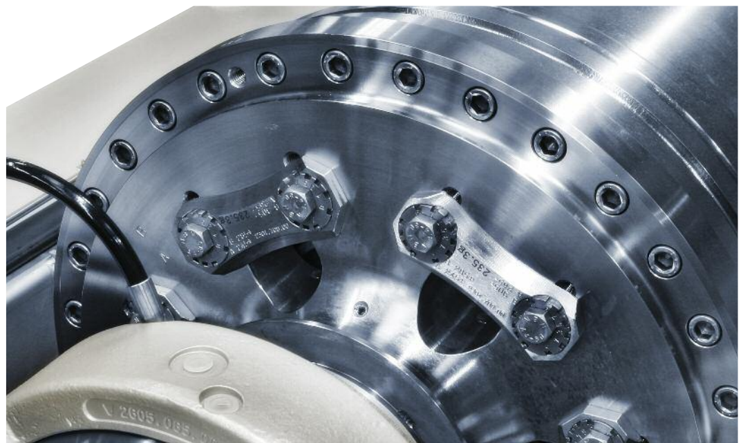
Rotor de décanteur avec des plaques de réglage de l'anneau liquide de type excentrique
