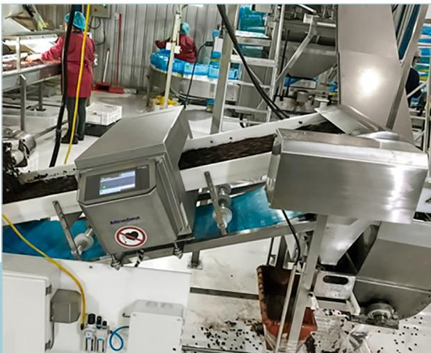
Monté sur un système de motorisation incliné, le détecteur de métaux constitue une solution compacte
