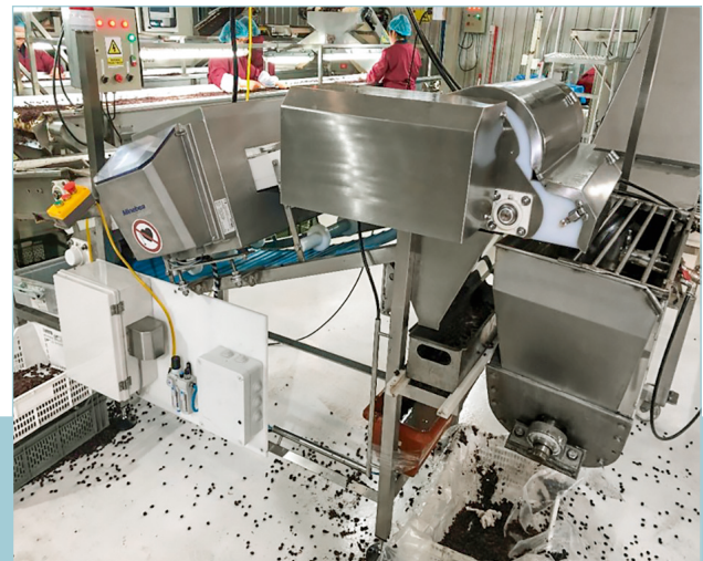
Tous les produits rejetés sont exclus du flux de produits au moyen d'un volet répartiteur bidirectionnel
