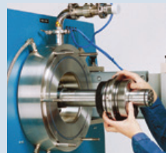
Étanchéité de l'arbre
