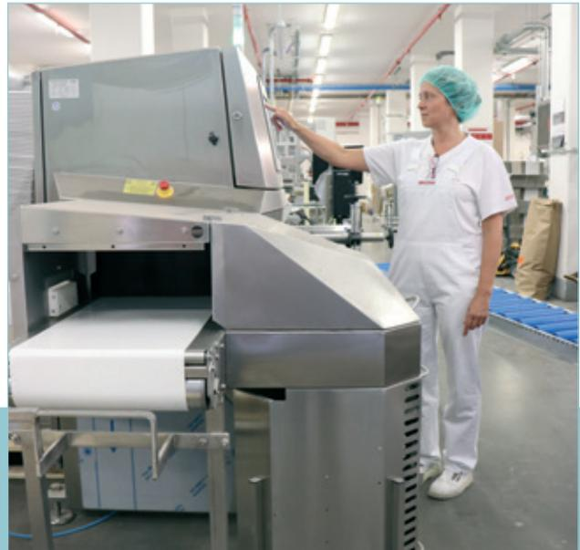
Chez Anona, le système d'inspection à rayons X Dymond est installé à la fin de la ligne de production, en tant que point de contrôle critique
