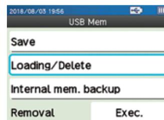
En se connectant à la clé USB (option), il est possible de sauvegarder et de lire les conditions et les résultats de mesure.
