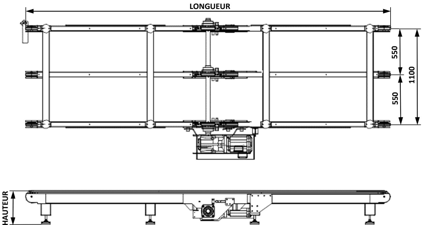
**Hauteur** (du sol jusqu'au-dessus des chaînes) : de 500 à 800 mm.
