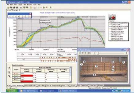
Logiciel d'analyse Kiln Tracker
