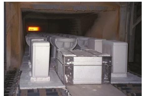
Système Kiln Tracker dans un four à rouleaux pour articles de table
