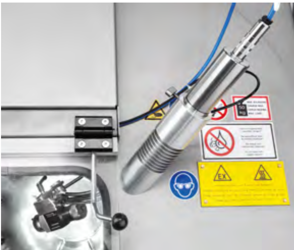
Capteur IR de mesure de la température des pièces
