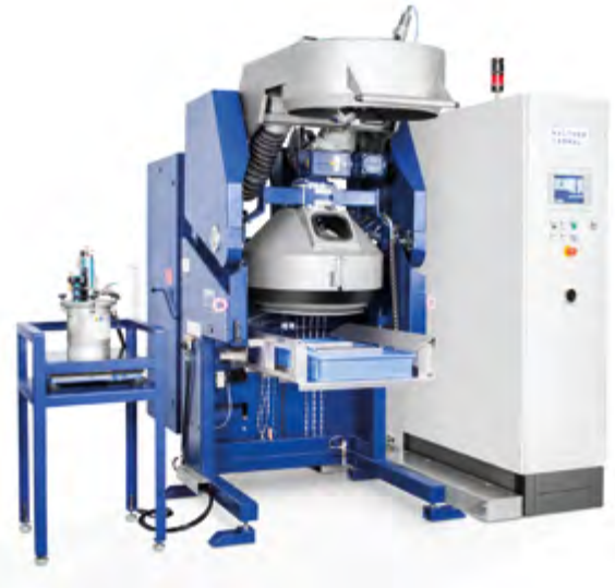
Tambour en position de vidage avec sa table de déchargement
