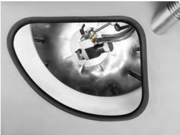
Aperçu de l'enceinte de pulvérisation
