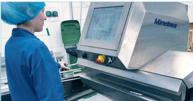
Le système d'inspection à rayons X Dylight détecte avec fiabilité les corps étrangers lors des processus de production
