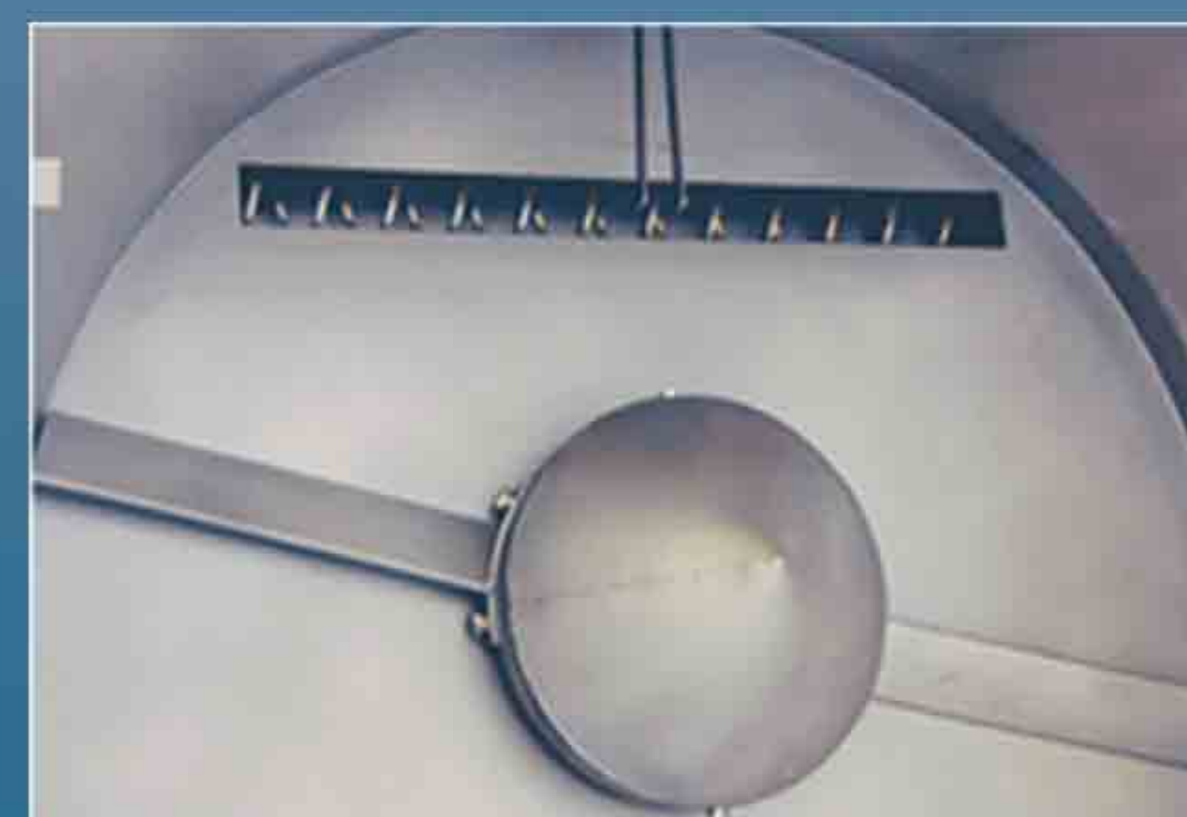
Fond plat avec système de dévoutage et de dosage mécanique
