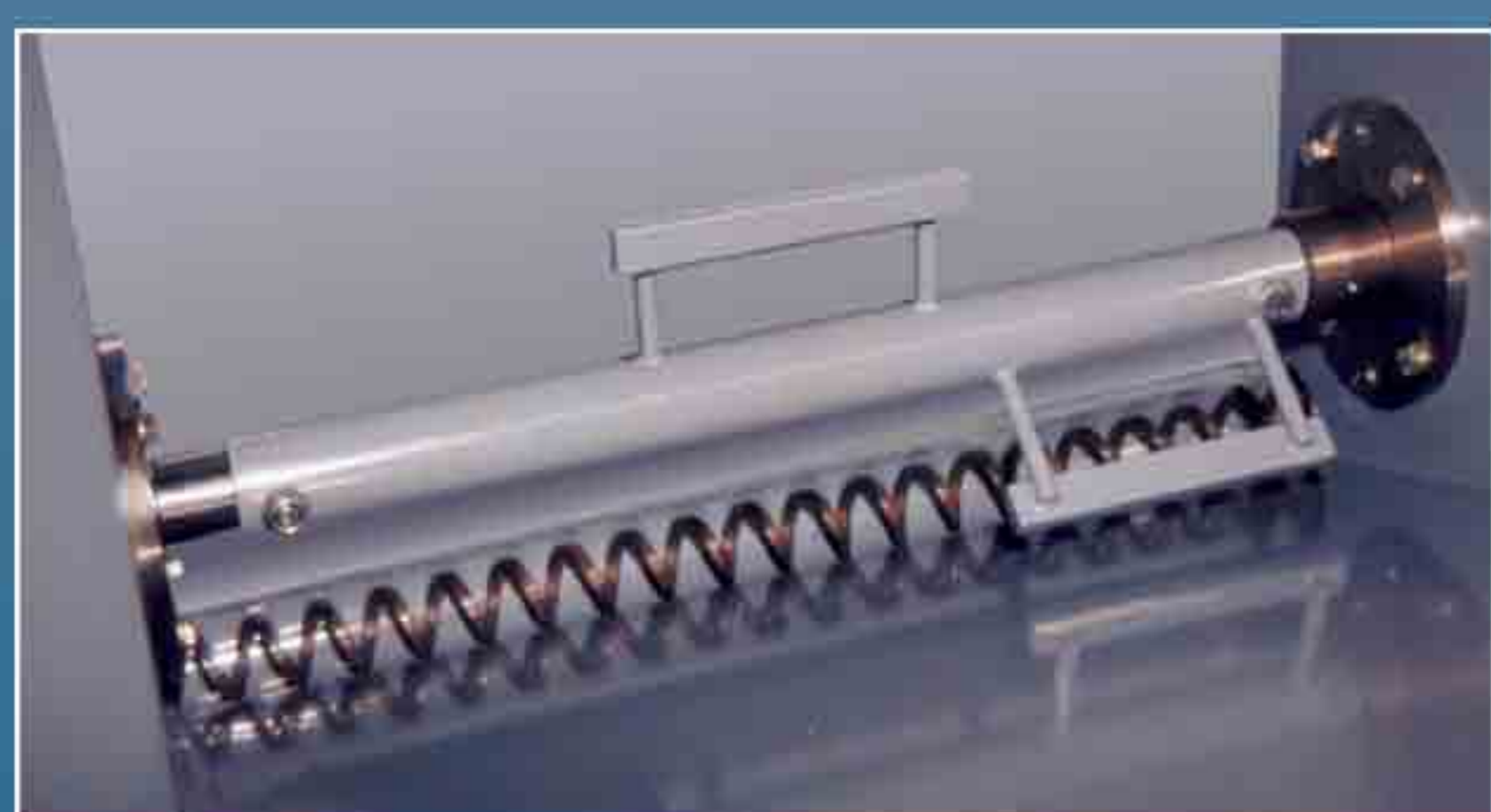
Trémie de réception matière type FW avec système de dévoutage horizontale
