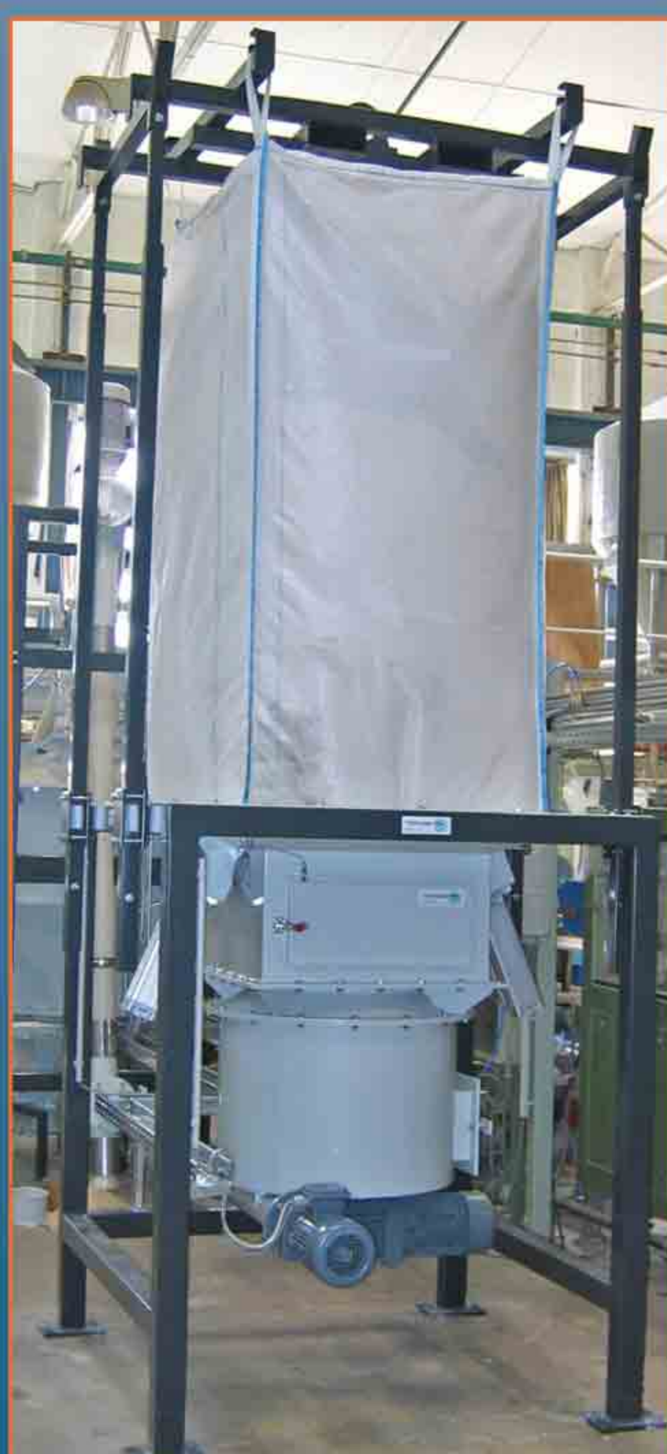
Station de vidange Big-Bag avec châssis supérieur réglable en hauteur, adaptable à différentes tailles de Big-Bag
