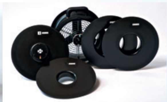
Des anneaux BlowerDoor Standard jusqu'à 1991 (à gauche), des anneaux BlowerDoor Standard depuis 1992 (au milieu), des anneaux BlowerDoor MiniFan depuis 2014 (à droite)
