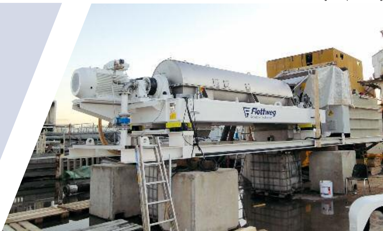
Décanteur Flottweg dans un procédé de forage
