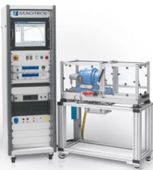
Fig. 6: Banc de test personnalisé avec freins WB Série
