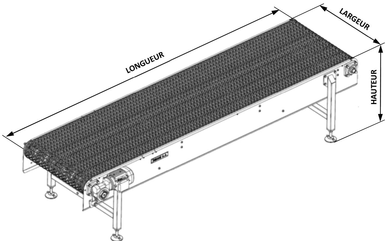
**Hauteur** (du sol jusqu'au niveau du tapis) : de 500 à 1 500 mm.
