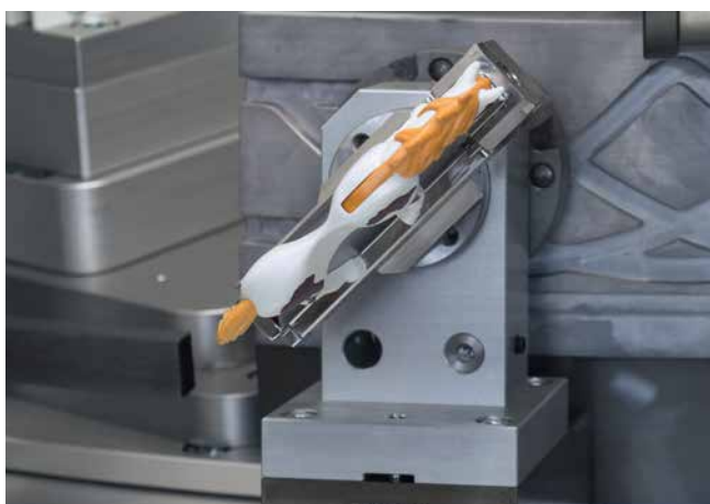
Posage avec retournement mécanique pour une impression recto-verso sur les jouets.
