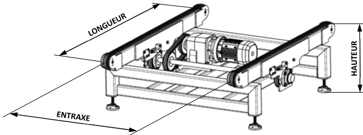
**Hauteur** (du sol jusqu'au-dessus des chaînes) : de 500 à 800 mm.
