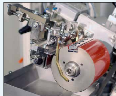
Fig. : Cylindre installé dans la tête de marquage d'impression rotative
