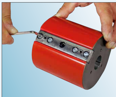
Fig. : Cliché magnétique tramé « R » monté sur cylindre
