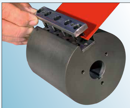
Fig. : Cliché magnétique tramé « R » avant cintrage
