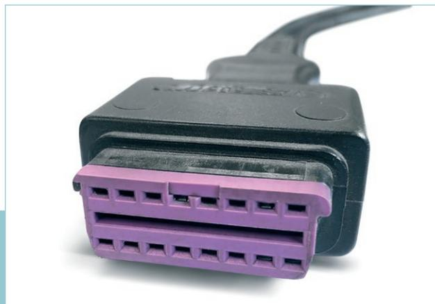
Exemple de connecteur mâle (chaque trou à la surface du connecteur est continu et nécessite une voie propre)
