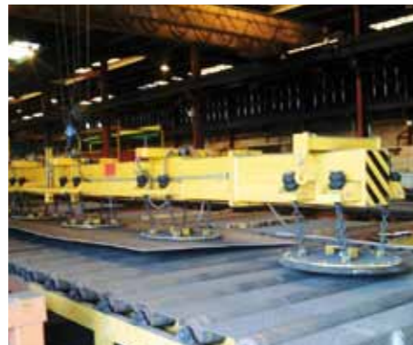
Palonnier grande dimension pour tôle à forte ondulation équipé de ventouses munies de compensateur de niveau. CMU : 12T.
