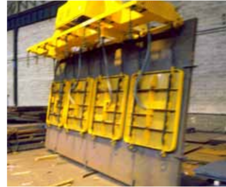
Palonnier pour stockage de tôle forte horizontale/verticale CMU : 10 T munie de ventouses à joint à lèvres de grande dimension 1400x1400 mm.
