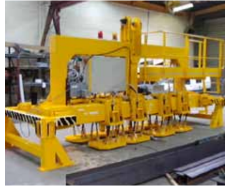
Palonnier destiné à la manutention de lingots d'aluminium.
