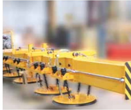
Palonnier grand gabarit CMU : 12T pour la manutention de tôle forte.
