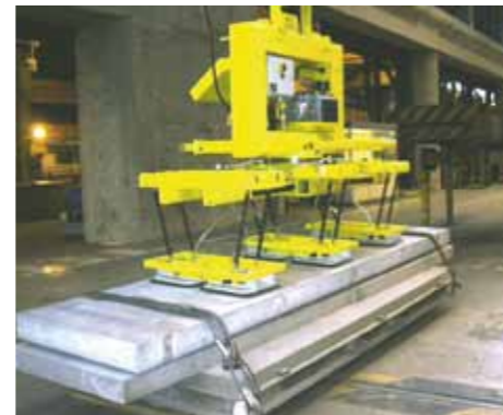
Palonnier a multi outillage pour la manutention de bloc aluminium.
