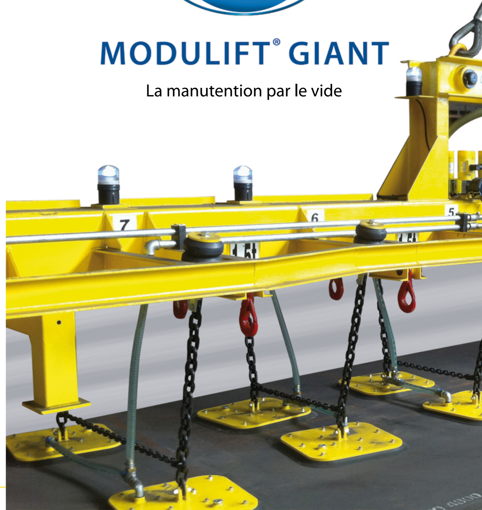
Palonnier pour stockage de tôle forte horizontale/verticale CMU : 10 T munie de ventouses à joint à lèvres de grande dimension 1400x1400 mm.
