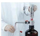
sur flacons ont abouti à la production de pistons et de cylindres de haute précision. Ceux-ci sont adaptés individuellement pour obtenir un système d'étanchéité sans usure avec des propriétés de glissement optimales. Il en résulte une distribution facile et agréable.
