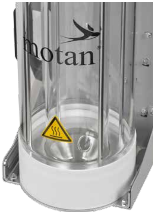
trémie de séchage entièrement en verre
