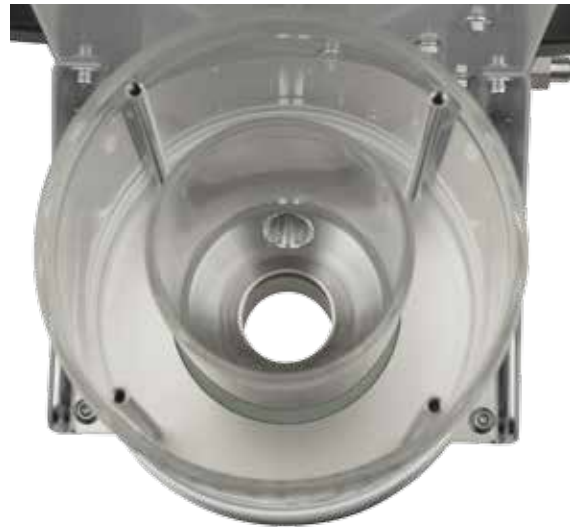
Détail de l'entrée de l'air sec et du diffuseur d'air
