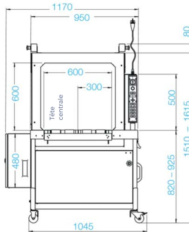
\*Mesures diverses avec option d'extension de la table pour MP-6 (600 x 600 mm)
