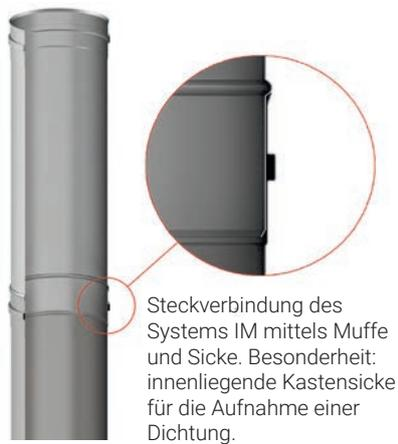
Steckverbindung des Systems IM mittels Muffe und Sicke. Besonderheit: innenliegende Kastensicke für die Aufnahme einer Dichtung.
