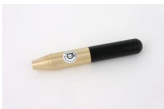
**Bobine d'émission « A »**, étanche (16 bars). Émetteur pour la détermination exacte de l'extrémité de la sonde en fibre de verre, localisable jusqu'à une profondeur de **5 m** environ. **Fréquence « A » ou 42 kHz, environ 10 heures de service.**
