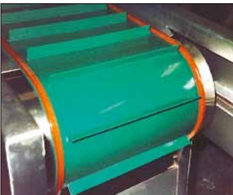
...avec rives trapézoïdales et tasseaux
