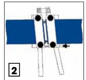
Introduire les extrémités de la courroie plate ou de la bande dans la pince appropriée en les laissant dépasser à l'intérieur de 5 mm de chaque côté.
