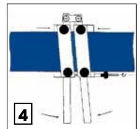
Ouvrir la pince, retirer rapidement le fer et refermer aussitôt en serrant proportionnellement à la section de la bande.
