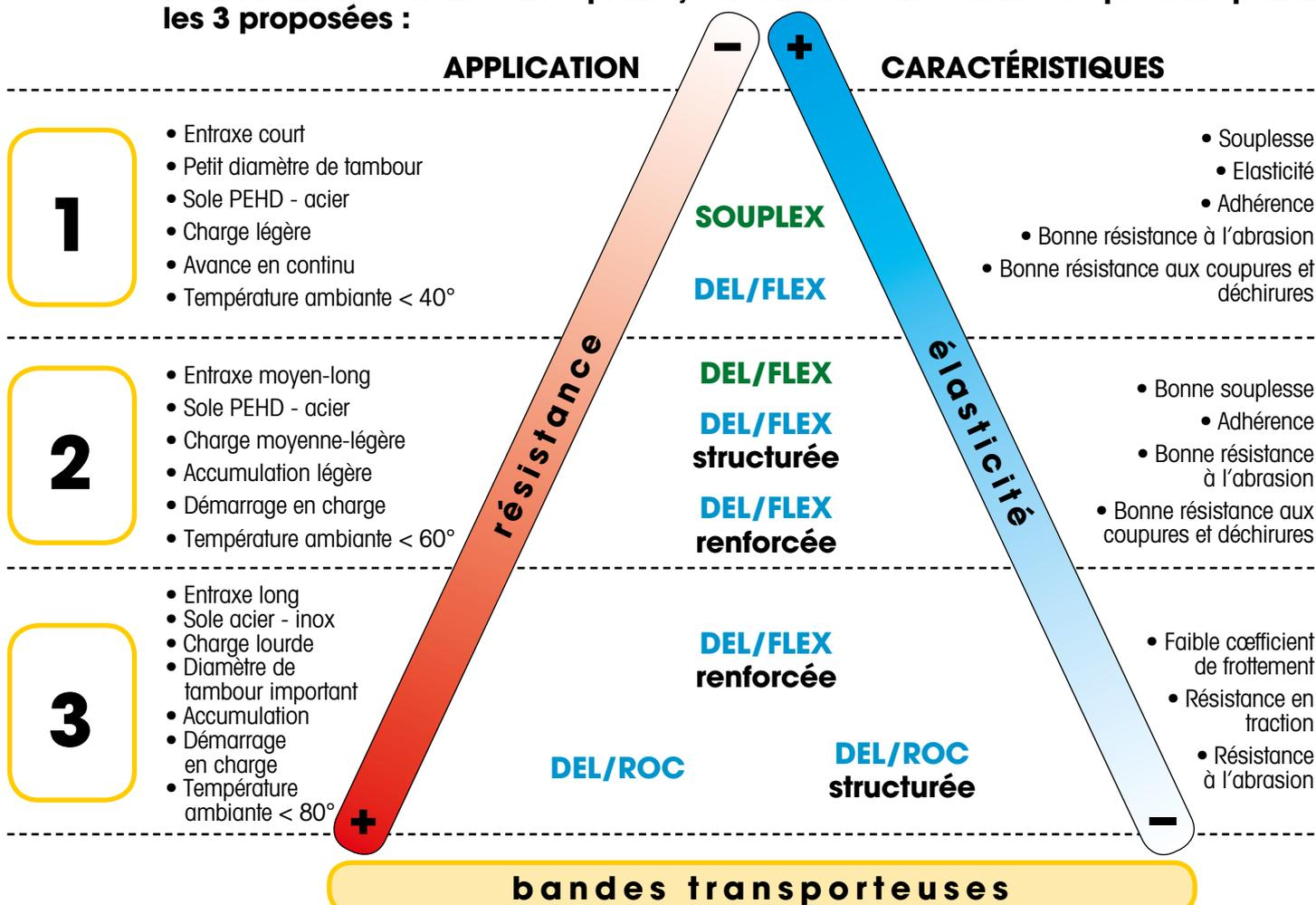
Dans la famille sélectionnée, choisir une qualité de bande dont les caractéristiques générales telles que : **résistance, dureté, coefficient de frottement, tension, température d'utilisation**, sont les plus proches de celles recherchées.
