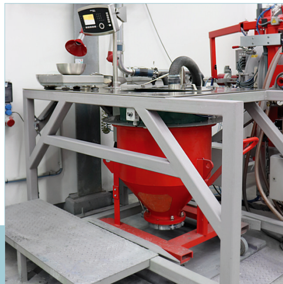
Les cuves de mélanges peuvent être amenées facilement sur la balance de sol IF. Le contrôleur de pesage traite les résultats de mesure des deux points de pesée et exécute le processus de formulation
