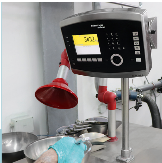
Le pesage exact des pigments et additifs est réalisé à l'aide de la balance de table. L'installation d'aspiration garantit une application sans aucune poussière
