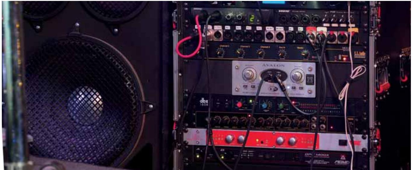
Lors de la connexion de l'amplificateur et du haut-parleur, la section du câble doit être aussi grande que possible afin de transmettre une puissance élevée avec de faibles pertes et d'amortir la contre-fréquence électromagnétique générée dans le haut-parleur par la résistance interne de l'amplificateur.
